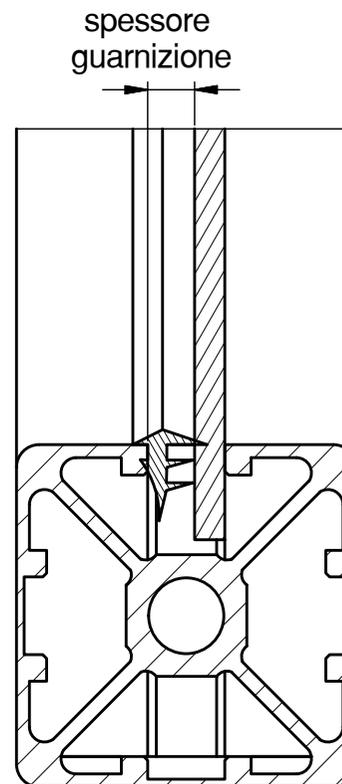
**SPESSORE GUARNIZIONE=LARGHEZZA CAVA-SPESSORE TAMPONAMENTO**
